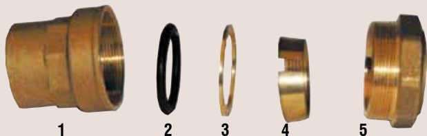
Eléments: 1 = Corps en laiton 2 = Joint O-Ring 3 = Bague de pression 4 = Bague de crantage 5 = Ecran en laiton
