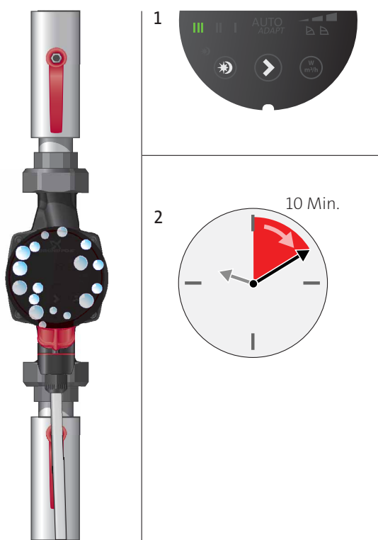
Fig. 24 Purge du circulateur
