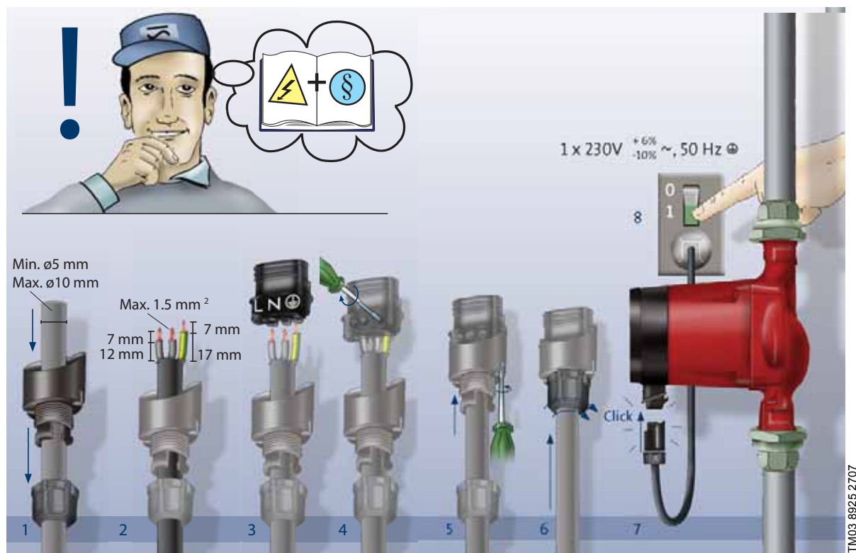
Fig. 6 Branchement électrique
