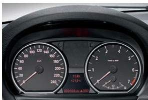
■ Tableau de bord avec instruments analogiques et éclairage orange par transparence pour l'indicateur de vitesse et le compteur. Ordinateur de bord avec affichage à cristaux liquides pour le totaliseur de distance parcourue et le totaliseur partiel.
