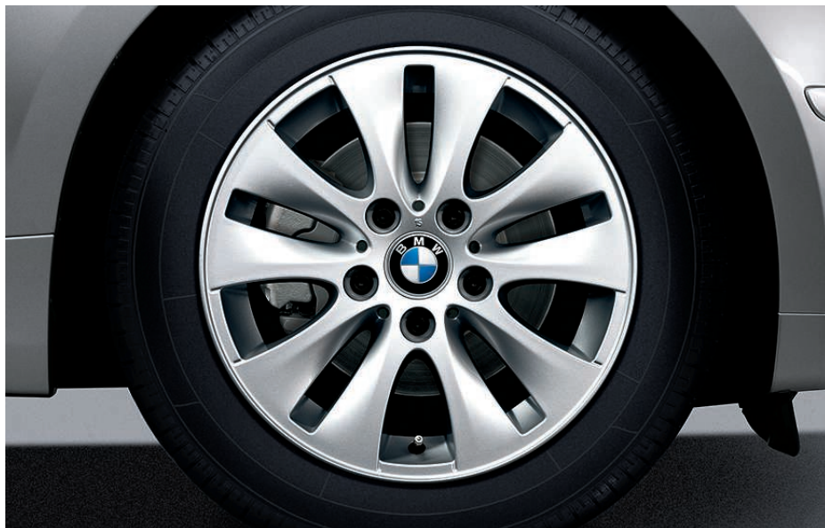
□ Jantes en alliage léger 16" (41 cm) style 229 à rayons en V 1 . Dimensions : 6,5 J x 16, pneumatiques 195/55 R 16 (BMW 116i, 118i, 116d et 118d) ; 7 J x 16, pneumatiques 205/55 R 16 (BMW 120i et 120d).
