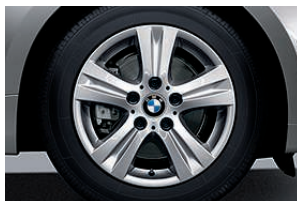
□ Jantes en alliage léger 16" (41 cm) style 222 à rayons doubles 1 . Dimensions : 7 J x 16, pneumatiques 205/55 R 16.
