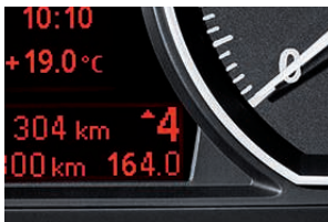
■ Indicateur de changement de rapport pour les modèles avec boîte de vitesses manuelle à 6 rapports. Il favorise une conduite économique en indiquant le moment idéal pour passer le rapport supérieur ou rétrograder en fonction du style de conduite. Il vous conseille notamment de changer de vitesse à l'accélération si un autre rapport permet d'accélérer suffisamment vite en consommant moins.
