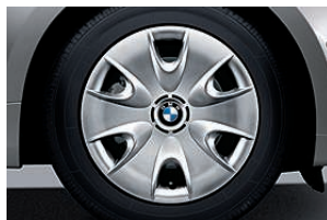
■ Jantes en acier 16" (41 cm) avec enjoliveur intégral 1 . Dimensions : 6,5 J x 16, pneumatiques 195/55 R 16 (de série sur BMW 116i, 118i, 116d et 118d) ou 7 J x 16, pneumatiques 205/55 R 16 (de série sur BMW 120i et 120d).
