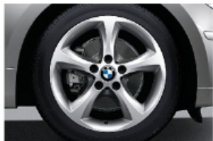
□ Jantes en alliage léger 17" style 256 à rayons en étoile avec pneumatiques RSC permettant le roulage à plat. Dimensions : 7 J x 17 pouces, pneumatiques 205/50 R 17 (de série sur BMW 130i).
