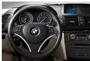
□ Volant Sport gainé cuir multifonctions (diamètre 369 mm), à trois branches, avec inserts chromés et touches multifonctions permettant de commander l'autoradio ou le téléphone (option). De série sur BMW 130i et 123d.
