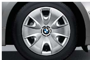
■ Jantes en acier 16" avec enjoliveur intégral 1 . Dimensions : 6,5 J x 16 pouces, pneumatiques 195/55 R 16 (de série sur BMW 116i, 118i, 116d et 118d) ou 7 J x 16 pouces, pneumatiques 205/55 R 16 (de série sur BMW 120i et 120d).
