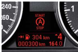
■ Affichage de l'arrêt automatique du moteur (sur les motorisations quatre cylindres avec boîte de vitesses manuelle à 6 rapports). Lorsque la fonction d'arrêt et de redémarrage automatique du moteur a coupé le moteur (à un feu tricolore ou dans un embouteillage), le conducteur en est informé via un symbole sur l'écran d'information. Ce dernier s'éteint à nouveau lorsque le moteur redémarre.
