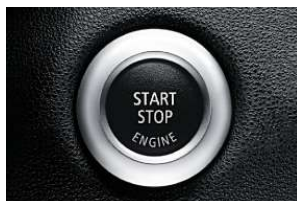
■ Bouton de démarrage « Start/Stop » . Lorsque la clé à télécommande est insérée, il suffit d'appuyer sur le bouton pour démarrer ou arrêter le moteur. □ Accès Confort : il permet de verrouiller, de déverrouiller ou de démarrer la BMW Série 1 sans avoir à manipuler la clé à télécommande.
