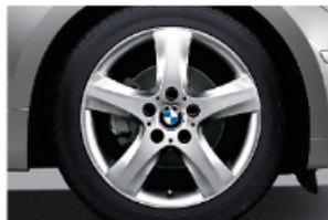
□ Jantes en alliage léger 17" style 142 à rayons en étoile avec monte pneumatique mixte RSC permettant le roulage à plat. Dimensions : 7 J x 17 pouces à l'avant, pneumatiques 205/50 R 17 ; 7,5 J x 17 pouces à l'arrière, pneumatiques 225/45 R 17.
