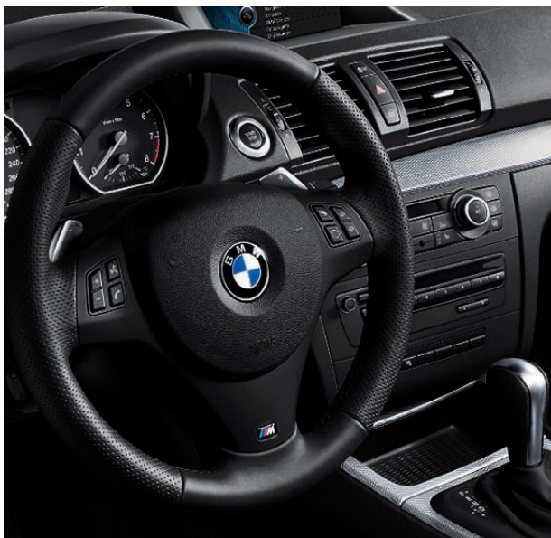
□ Palettes de changement de rapport au volant pour une conduite particulièrement dynamique (en combinaison avec la boîte de vitesses automatique à 6 rapports avec Steptronic) ; disponibles pour le volant Sport gainé cuir ou le volant M gainé cuir.
