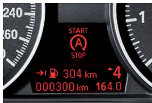
■ Affichage de l'arrêt automatique du moteur (sur les motorisations quatre cylindres avec boîte de vitesses manuelle à 6 rapports). Lorsque la fonction d'arrêt et de redémarrage automatique coupe le moteur (à un feu tricolore ou dans un embouteillage), le conducteur en est informé via un symbole sur l'écran d'information. Ce dernier s'éteint à nouveau lorsque le moteur redémarre.
