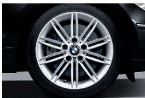
□ Jantes en alliage léger 17" (43 cm) style 207 M à rayons doubles avec monte pneumatique mixte RSC permettant le roulage à plat. Dimensions : 7 J x 17 à l'avant, pneumatiques 205/50 R 17 ; 7,5 J x 17 à l'arrière, pneumatiques 225/45 R 17. De série uniquement sur Édition Sport.
