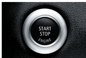
■ Bouton de démarrage « Start/Stop » . Lorsque la clé radiocommandée est insérée, il suffit d'appuyer sur le bouton pour démarrer ou arrêter le moteur.
