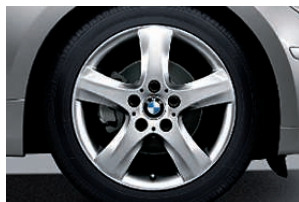
□ Jantes en alliage léger 17" (43 cm) style 142 à rayons en étoile avec monte pneumatique mixte RSC permettant le roulage à plat. Dimensions : 7 J x 17 à l'avant, pneumatiques 205/50 R 17 ; 7,5 J x 17 à l'arrière, pneumatiques 225/45 R 17.
