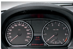
■ Tableau de bord avec instruments analogiques et éclairage orange par transparence pour l'indicateur de vitesse et le compte-tours. Ordinateur de bord avec affichage à cristaux liquides pour le totaliseur de distance parcourue et le totaliseur partiel.
