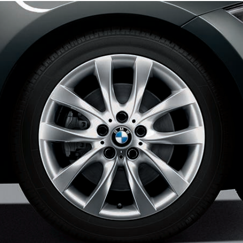
Jantes en alliage léger 18" (46 cm) style 217 à rayons en V avec monte pneumatique mixte RSC permettant le roulage à plat. Dimensions : 7,5 J x 18 avec pneumatiques 215/40 R 18 à l'avant et 8,5 J x 18 avec pneumatiques 245/35 R 18 à l'arrière (option, de série sur BMW 135i).
