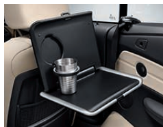
Système voyage multifonction (tablette rabattable). Fixation sur les tiges des appuis-tête avant.
