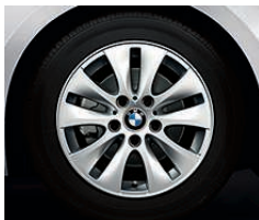
Jantes en alliage léger 16" (41 cm) style 229 à rayons en V 1 . Dimensions : 6,5 J x 16, pneumatiques 195/55 R 16 (de série sur BMW 118i et 118d) ; 7 J x 16, pneumatiques 205/55 R 16 (de série sur BMW 120i et 120d), également disponibles pour jeu de roues hiver complètes en Accessoire d'Origine BMW. Uniquement sur BMW 120i, 118d et 120d.
