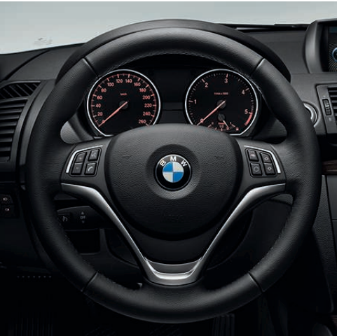
Volant Sport gainé cuir avec touches multifonctions (diamètre 369 mm), inserts chromés, trois branches. Les touches multifonctions servent à la commande de l'autoradio ou du téléphone.
