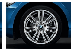
■ Jantes M en alliage léger 17" (43 cm) style 383 M à rayons en étoile avec monte pneumatique mixte. Dimensions : 7,5 J x 17 à l'avant, pneumatiques 225/45 R 17 ; 8 J x 17 à l'arrière, pneumatiques 245/40 R 17.
