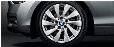
Jantes en alliage léger 17" (43 cm) style 381 Turbine. Dimensions : 7,5 J x 17, pneumatiques 225/45 R 17.
