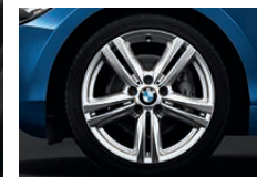
Jantes en alliage léger 18" (46 cm) style 386 M à rayons en étoile avec monte pneumatique mixte. Dimensions : 7,5 J x 18 à l'avant, pneumatiques 225/40 R 18 ; 8 J x 18 à l'arrière, pneumatiques 245/35 R 18 (de série sur la Finition M Sport).
