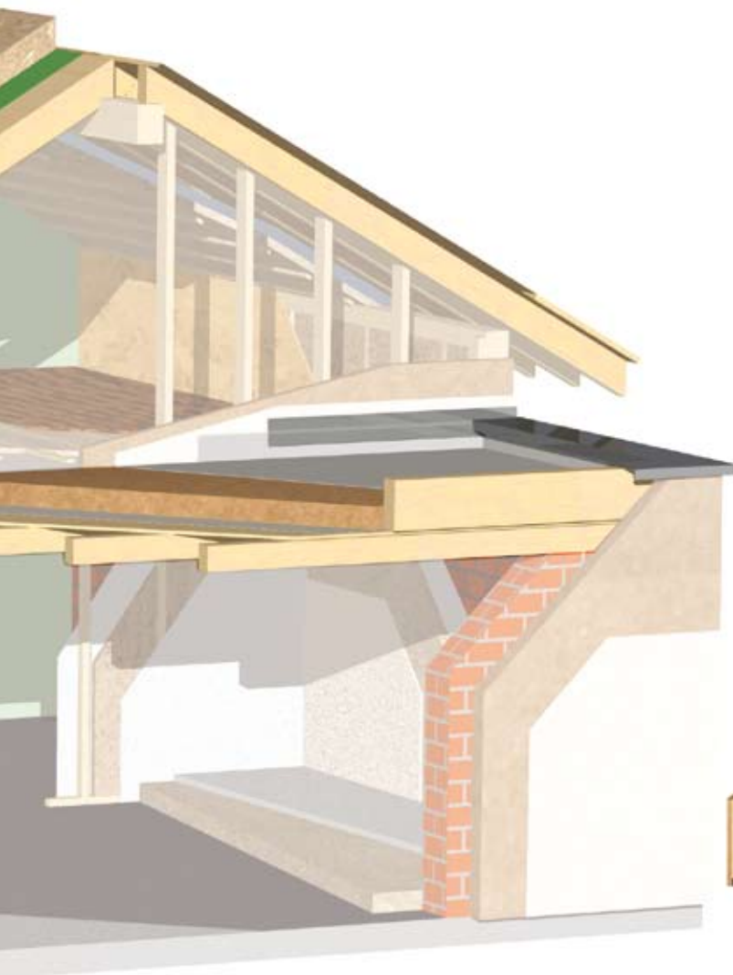
GUTEX Thermoflat sur une base en bois
