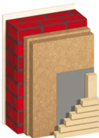
Construction ventilée sur un mur
