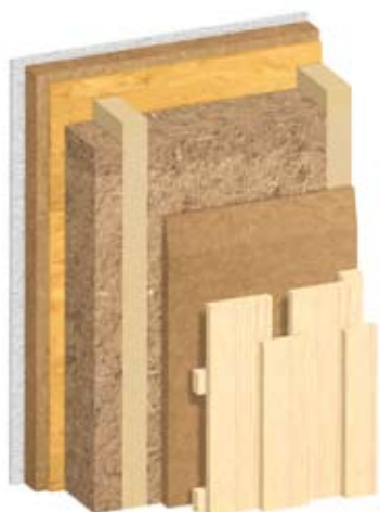
Construction ventilée sur montants en bois
