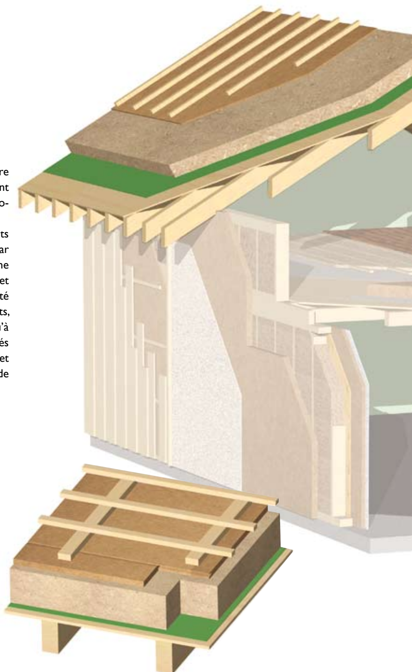
Structure d'une isolation de toiture GUTEX avec les panneaux GUTEX Thermosafe-homogen et GUTEX Multiplex-top
